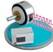
由於 FX 系列所有機型都內置高速計數器，故可通過簡易程式實現高速控制。
