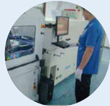
自動Coating產線 提高產品表面耐磨性
