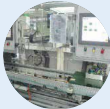
自動焊錫機械手臂 確保焊錫無誤差
